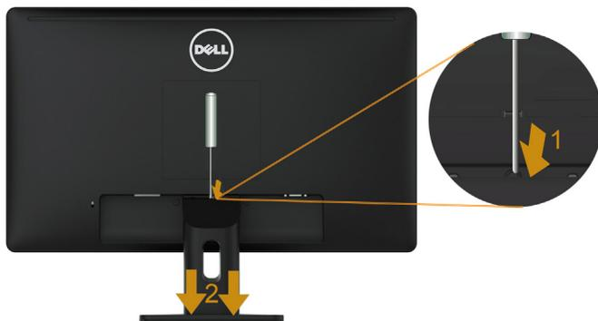
1. Utilisez un tournevis long pour enfoncer l'onglet de relâchement situé dans un trou juste au-dessus de la base.
