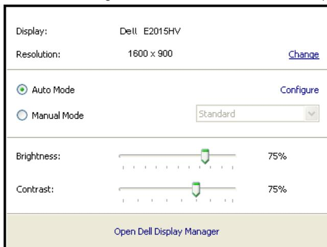
La boîte de dialogue Réglages rapides permet aussi d'accéder à l'interface d'utilisateur avancée du Gestionnaire d'affichage Dell, qui permet de régler les Fonctions basiques, de configurer le Mode auto et d'accéder à d'autres fonctions.
